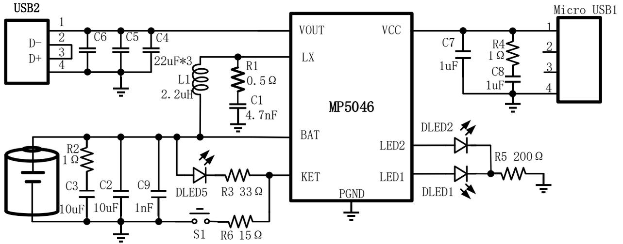
MP5046 带KEY键和手电筒应用电路
